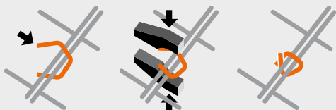
Sluiten van de ringkrammen
